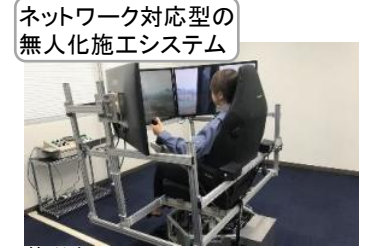
熊谷組・ 無人化施工システム
